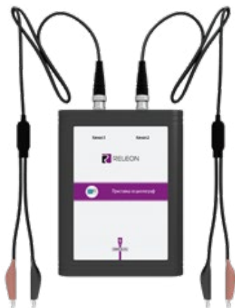
Рис. 1. Двухканальная приставка-осциллограф Releon
