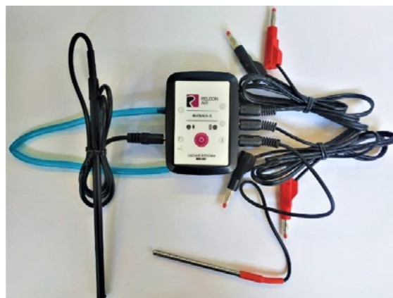
Рис. 9. Беспроводной мультидатчик Releon Air «Физика-5»
