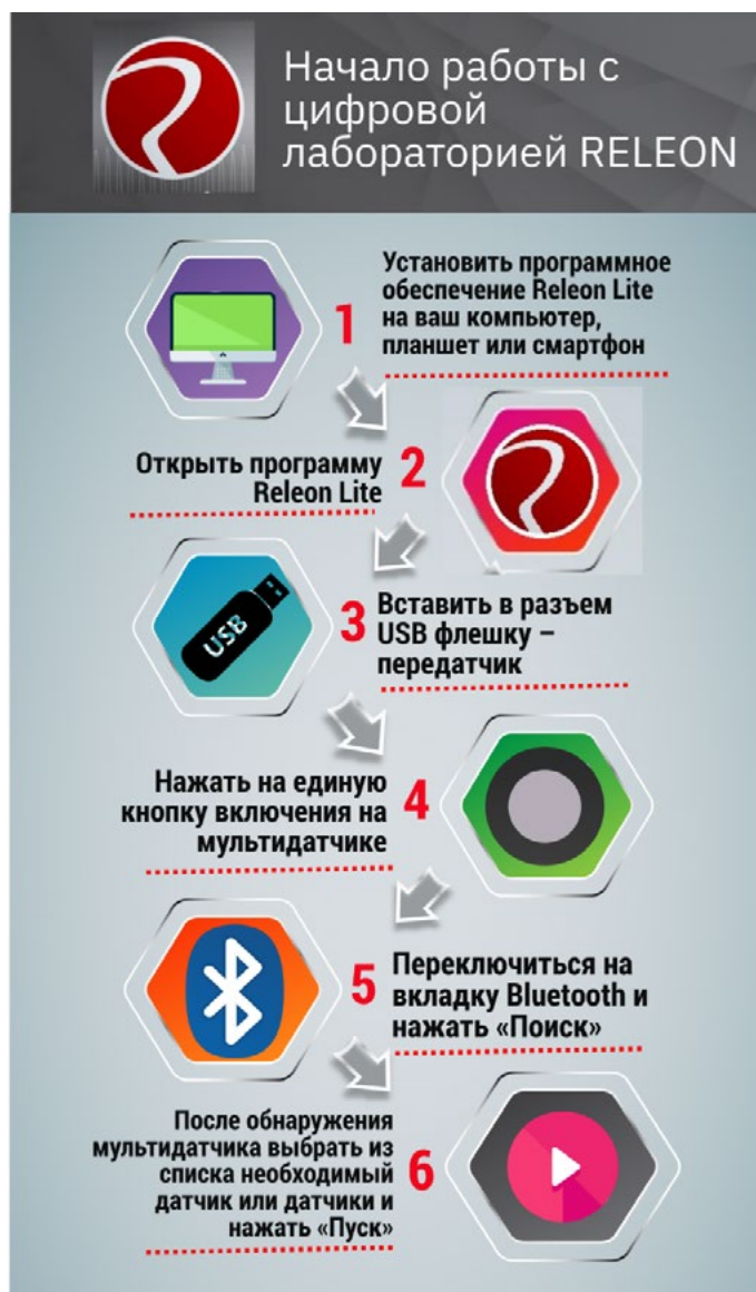
Рис. 21. Инфографика «Начало работы с цифровой лабораторией Releon»
